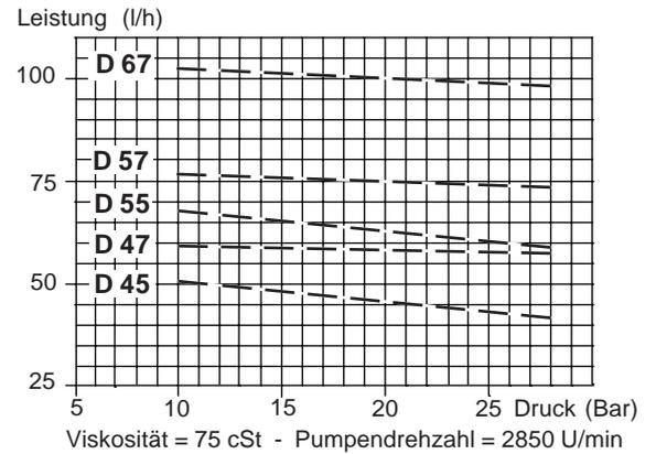
In den dargestellten Kurven ist bereits eine Abnutzung des Getriebes berücksichtigt. Achten Sie deshalb darauf, daß Sie bei der Wahl der Getriebekapazität, die Pumpe nicht überdimensionieren.
