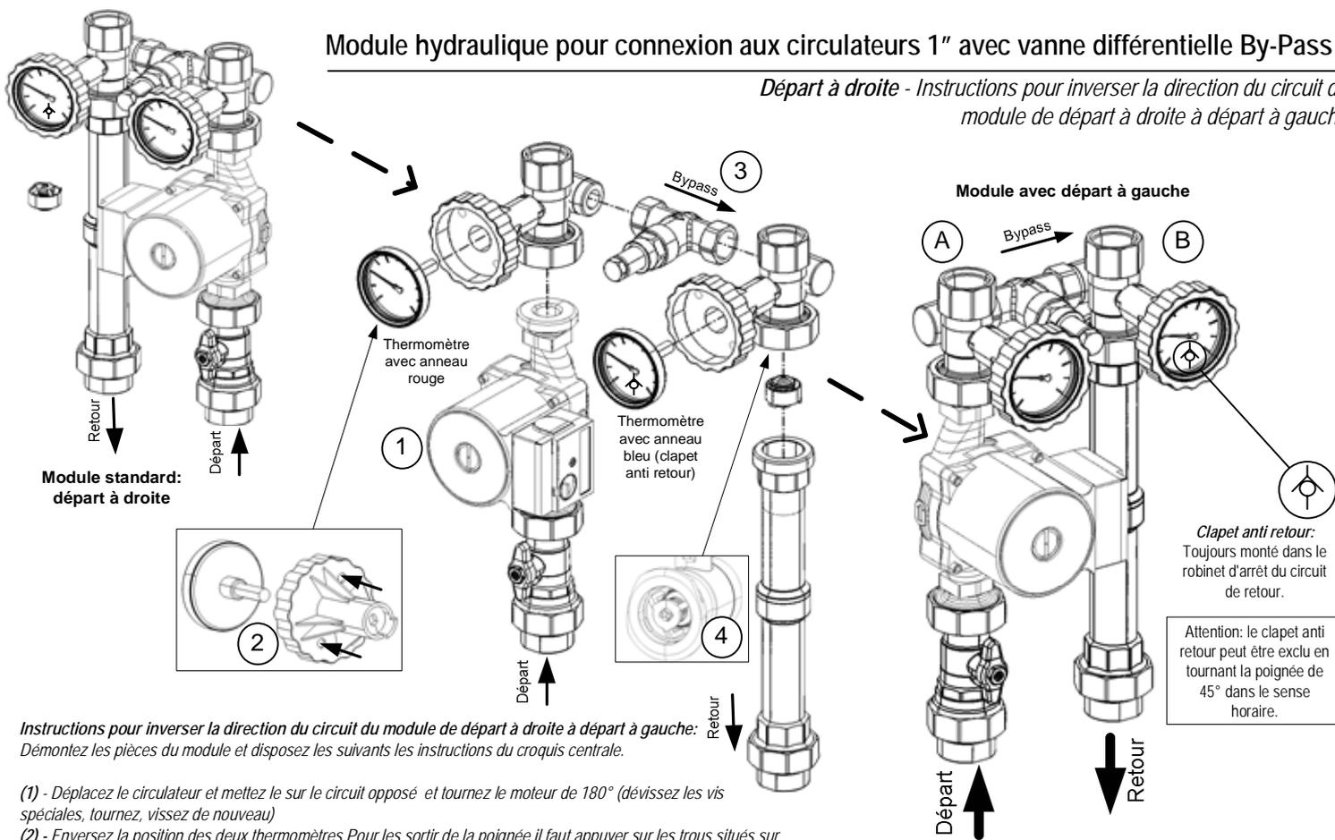
Instructions pour inverser la direction du circuit du module de départ à droite à départ à gauche: Démontez les pièces du module et disposez les suivants les instructions du croquis centrale.
