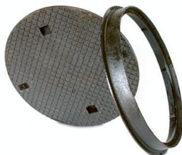
Der Aufnahmering wird schwimmend montiert, d.h. er liegt nicht auf dem Dom oder der Domverlängerung auf, sondern stützt sich auf das verdichtete Erdreich. Anschließend wird bis zur Oberkante des Aufnahmerings mit Erdreich verfüllt oder angeflastert.
