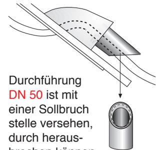
Durchführung **DN 50** ist mit einer Sollbruchstelle versehen, durch herausbrechen können Sie die Durchführung auf **DN 70** erweitern.
