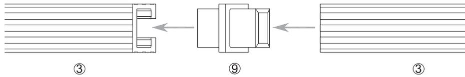
Schienenverbindungsstück ⑨ ins beide Montageschiene ④ rein schieben.
