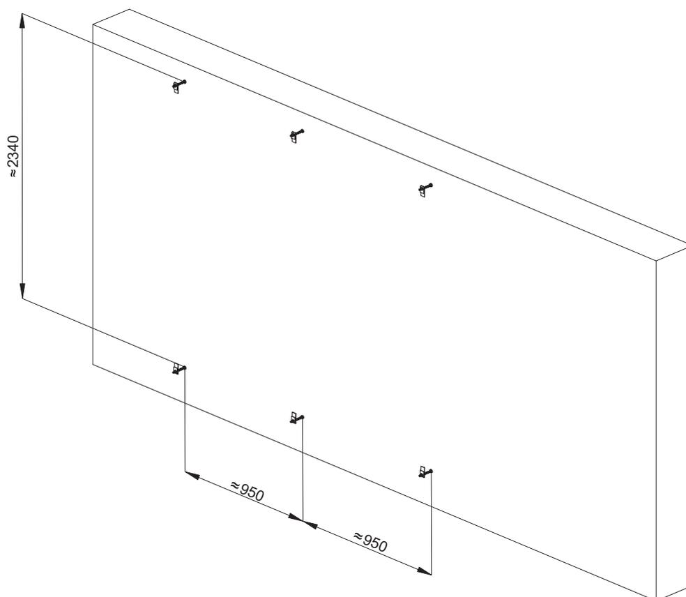
2. Montage der T-träger an die Haken und Befestigen des Kollektors mit Hilfe der Montageklipse.
