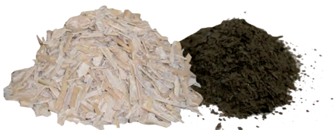
Kalk und Korrosionsprodukte – das unterschätzte Risiko.
