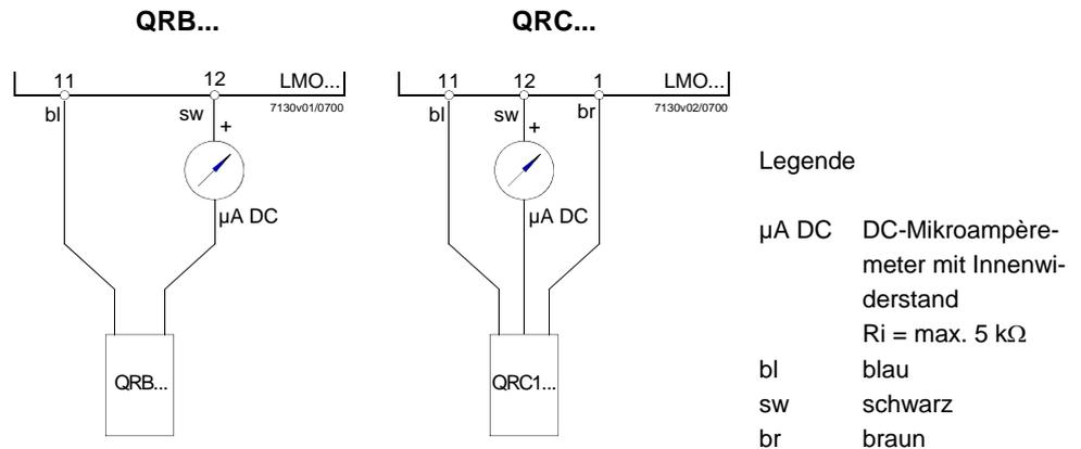
Alternativ kann zur Fühlerstrommessung auch das Diagnosetool OCI400 / mit PC-Software ACS400 / ACS410 verwendet werden. Hierzu entfällt der Anschluss des DC-Mikroampèremeters.
