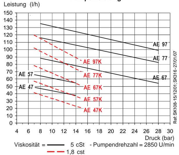
In den dargestellten Kurven ist bereits eine Abnutzung des Getriebes berücksichtigt. Achten Sie deshalb darauf, daß Sie bei der Wahl der Getriebekapazität, die Pumpe nicht überdimensionieren.
