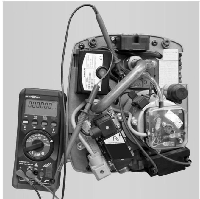
Abb. 24: Messgerät Ionisationsstrom
