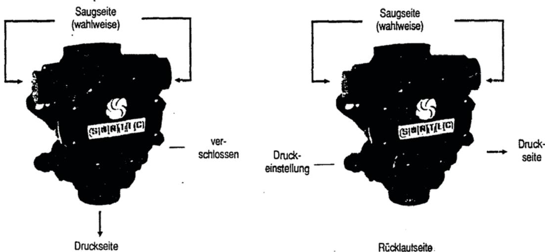
5. Pumpe, Filter und ggf. auch Saugleitung mit Öl befüllen. **Pumpe darf nicht trocken laufen!**
