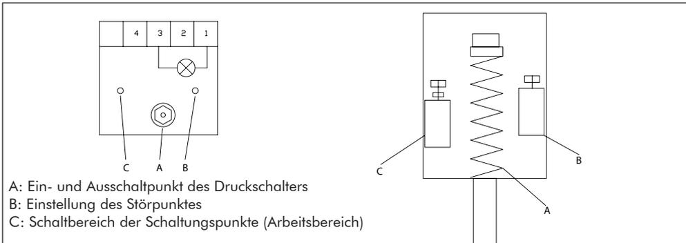
A. Um den Druck zu erhöhen (Werkseinstellung: 1,5-2,4 bar), muss die obere Schraubenmutter im Uhrzeigersinn gedreht werden, damit die Feder gespannt wird.
