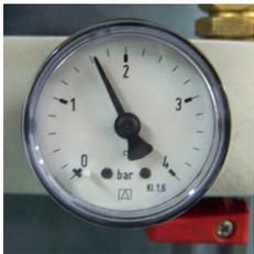
5. Taster am Druckschalter solange drücken bis das Licht erloschen ist. Dann arbeitet die Pumpe selbständig weiter bis der Maximaldruck von 2,5 bar erreicht ist.
