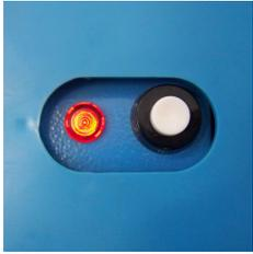
1. Die Lampe des Druckschalters leuchtet bei der Inbetriebnahme rot.
