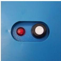
4. Taster an Druckschalter solange betätigen bis die Pumpe angesaugt hat. Eventuell Pumpwerk vorfüllen, hierzu einfach Filter entfernen und Pumpe mit Heizöl vorfüllen (empfohlen). Wenn Öl kommt, Absperrventil schließen und druckseitigen Anschluss herstellen.
