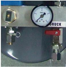
2. Kugelhahn am Druckanschluss (Verbraucherseite) öffnen.
