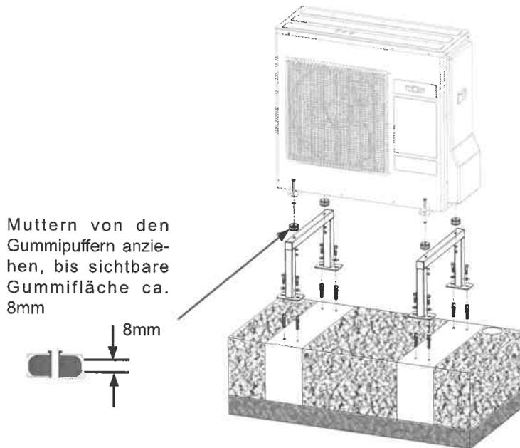
Gegossene ebene Bodensockel aus Beton mit ausreichend Frostschutzkies als Untergrund, Ausschnitt zur Leitungsdurchführung siehe Sockelplan
