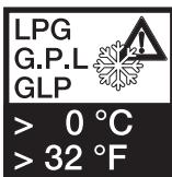
In Flüssiggasanlagen das VPS 504 nicht unter 0 °C betreiben. Nur für gasförmiges Flüssiggas geeignet, flüssige Kohlenwasserstoffe zerstören die Dichtwerkstoffe.
