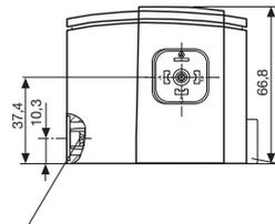
Verschlußschraube G 1/4 mit Dichtung
