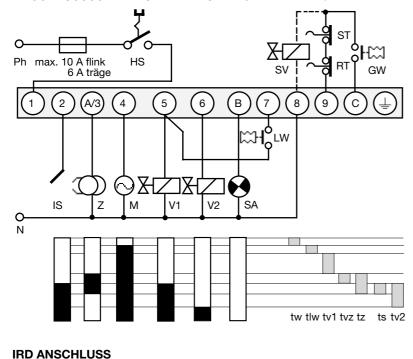
Hauptschalter HS GW . Gaswächter Sicherheitsthermostat ST RT Regelthermostat Ionisationssonde IS Zündung Brennermotor Μ V1 Magnetventil 1. Stufe V2 Magnetventil 2. Stufe Luftwächter LW SA Externe Störanzeige Sicherheitsventil SV Wartezeit Start tw max. Reaktionszeit tlw für Luftwächter überwachte Vorspülzeit tv1 tvz Vorzündzeit Zündzeit total tz Sicherheitszeit ts tv2 Verzögerung 2. Stufe
