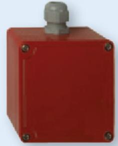
**Beschreibung** Zur Überwachung von Sauerstoffkonzentrationen. Auch in staubiger und schmutziger Umgebung einsetzbar. Zum Anschluss an die Gaswarngeräte GW-S, GW-S4 und GW-SK. Ausführung in Aluminium als Wandaufbaugeschäule. Anschlusskabel (abgeschirmt) 3 x 1,5 mm<sup>2</sup> Cu+-Schutzleiter, Hin- und Rückleiter (max. 100 Ohm Kabelwiderstand).
