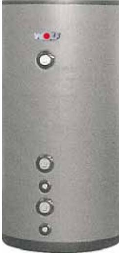
Pufferspeicher SPU-1-200 aus Stahl S 235 JR (St 37-2) gefertigt. Folienmantel in Wolf-Silber, ohne Korrosionsschutz der Behälterinnenwand, da der Einsatz nur in geschlossenen Heizungsanlagen als Pufferspeicher für Betriebswasser zulässig ist.
