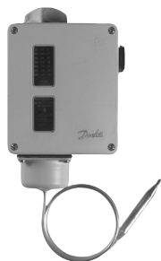
RT 107 mit zylindrischem Fernfühler, Deckel mit Fenster und Knopf für Handeinstellung
