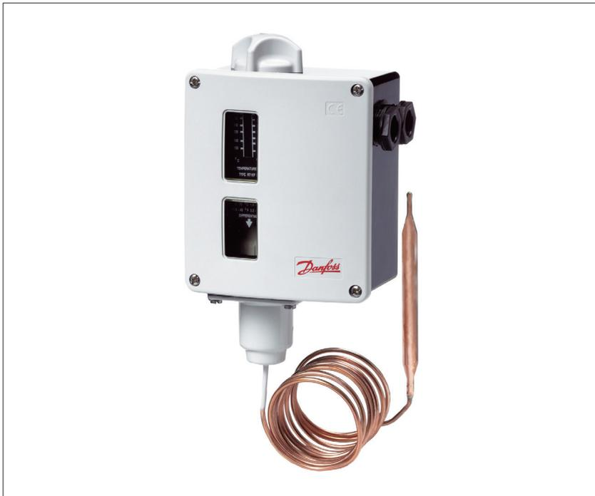
Die Thermostate RT integrieren einen temperaturgeregelten, einpoligen Wechsler, bei dem die Kontaktstellung von der Temperatur des Sensors und dem festgelegten Skalierwert abhängt.
