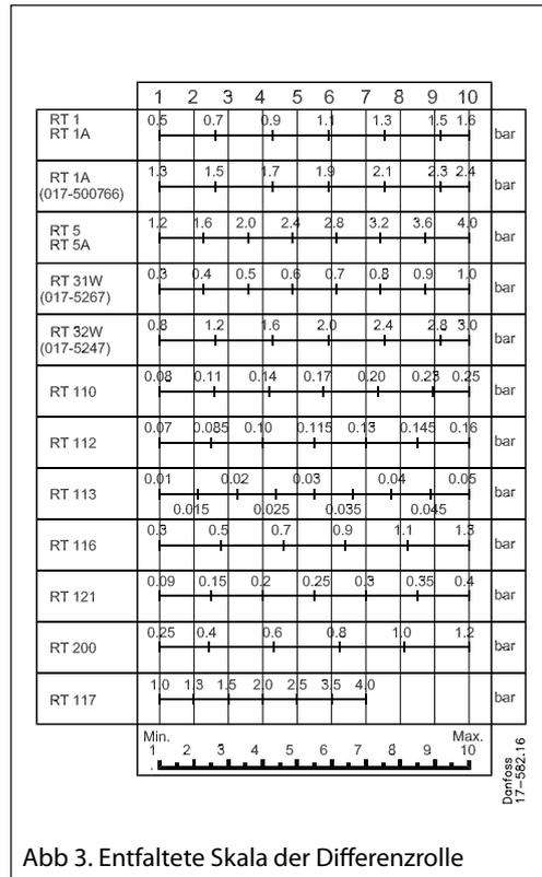
Abb 3. Entfaltete Skala der Differenzrolle
