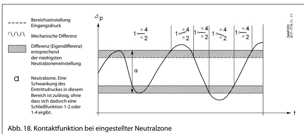
Abb. 18. Kontaktfunktion bei eingestellter Neutralzone
