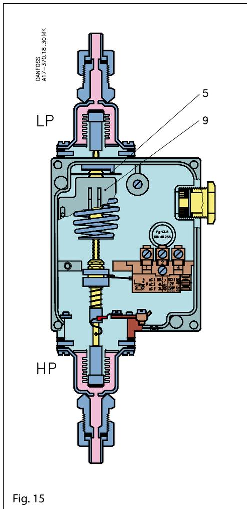
Nach Entfernung des Deckels wird die Einstellscheibe (5) zugänglich. Der Differenzdruck wird durch Drehen der Scheibe mittels eines Schraubenziehers eingestellt, während der Einstellwert auf der Skala (9) abgelesen wird.
