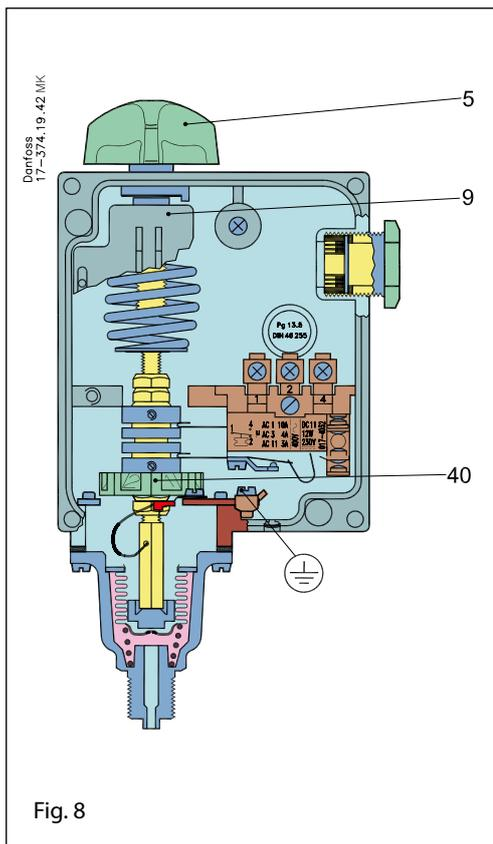
Druckschalter vom Typ RT-L sind mit einem Kontaktsystem mit einstellbarer Neutralzone ausgerüstet. Damit besteht die Möglichkeit der Anwendung von RT-Geräten für schwebende Steuerung. Eine Erläuterung der in diesem Zusammenhang verwendeten Terminologie folgt nachstehend:
