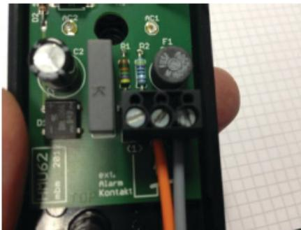
Dazu ist die Kreuzschlitzschraube auf der Rückseite zu lösen, so dass der Deckel abgenommen werden kann. Der Deckel ist vorsichtig abnehmen, damit die interne Verdrahtung nicht beschädigt wird. Das Kabel des externen Kontaktes wird durch die Kabelverschraubung in das Gerät geführt und an die Klemmen 2 + 3 angeschlossen. Beim Schließen des Deckels ist darauf zu achten, dass sowohl die interne Verdrahtung als auch die Aderleitungen des Kontaktgebers nicht beschädigt werden.
