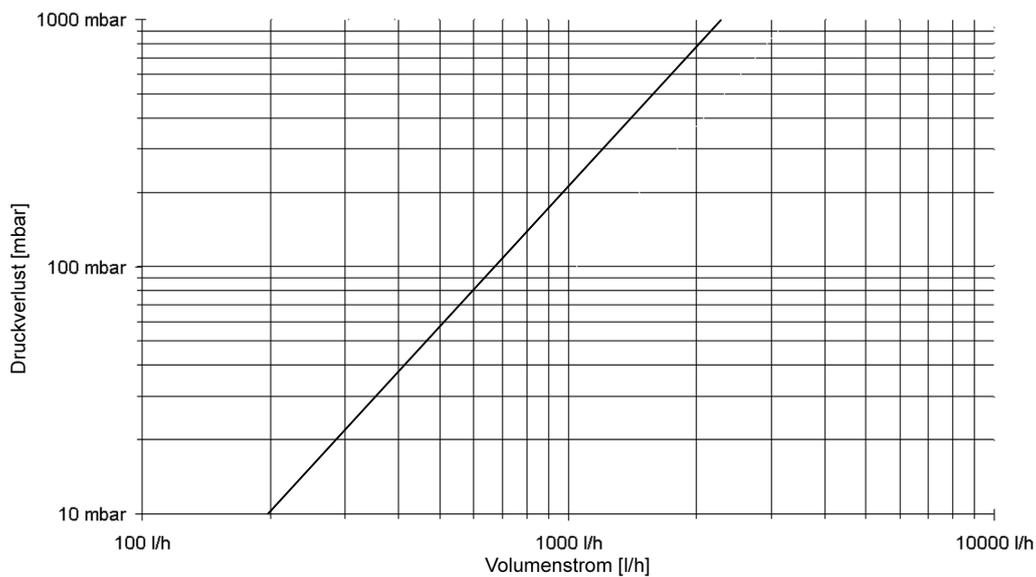
Bild 2: Widerstandsdiagramm
