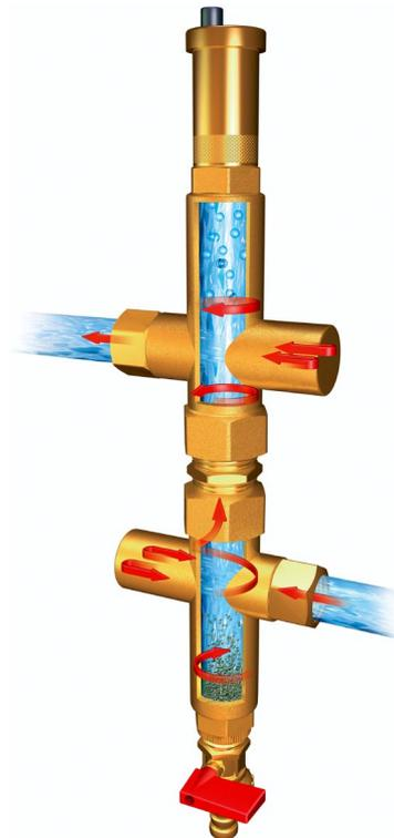
Bild 1: Funktionsprinzip
