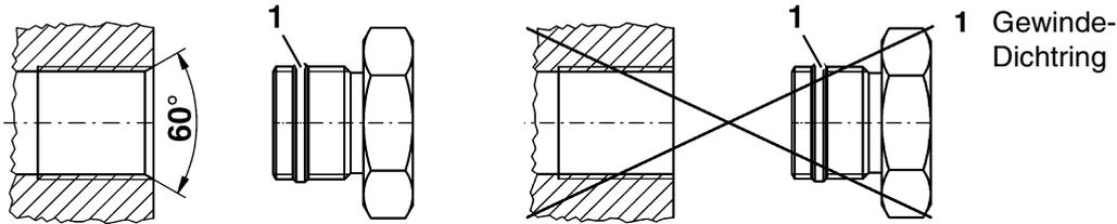
Bild 1: Richtig: Muttergewinde anfasen Bild 2: Falsch
