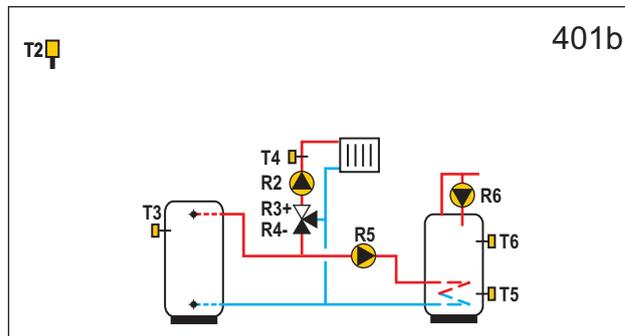
**WDC10B** Wärmespeicher, Mischerheizkreis, Brauchwassererwärmer.
