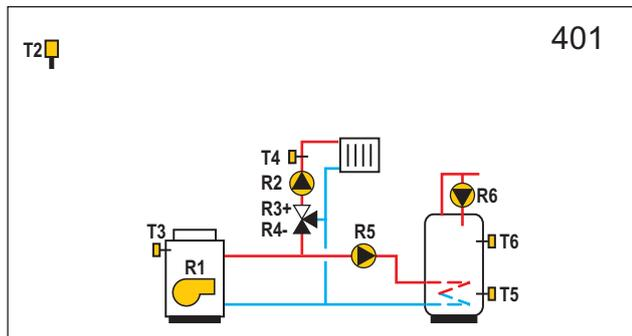
**WDC10B** Ölkessel, Mischerheizkreis, Brauchwassererwärmer.
