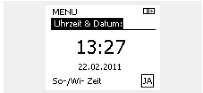
Wird der Regler als Folgeregler in einem System mit Führungsregler und Folgeregler eingesetzt, werden die Uhrzeit und das Datum automatisch (über den Kommunikationsbus ECL 485) vom Führungsregler übernommen.
