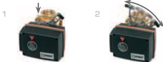
1 Drücken Sie zum manuellen Betrieb des Mischers den Knopf und verwenden Sie den Hebel. Der elektrische Strom wird solange automatisch unterbrochen, wie sich der Knopf in der unteren Stellung befindet.
