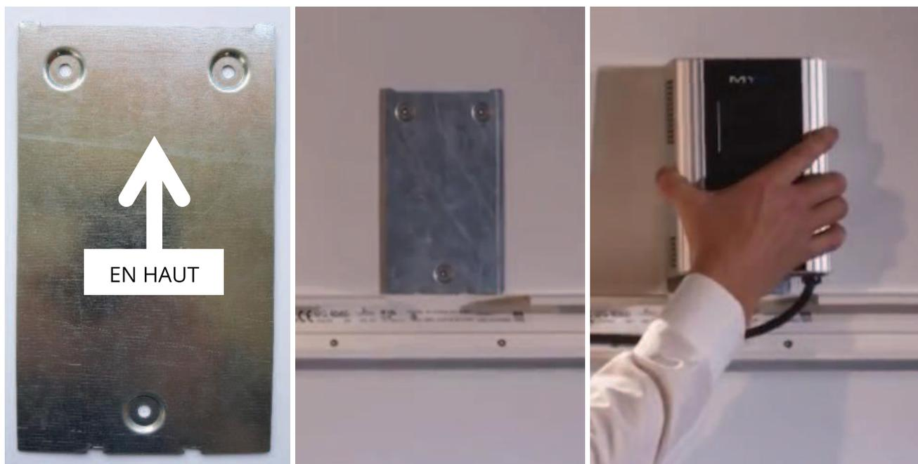
Pour la fixation au support mural, accrocher l'AC•THOR sur le support mural à l'aide des deux fentes supérieures, puis fixer les à la face inférieure à l'aide d'un verrouillage (glisser vers la gauche).
