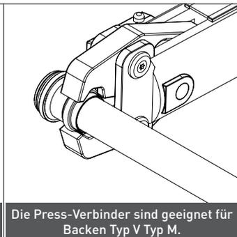
Die Press-Verbinder sind geeignet für Backen Typ V Typ M.
