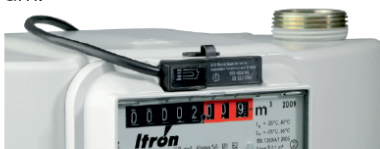
Zählwerk der Baureihe "o" mit NF-Impulsgeber
