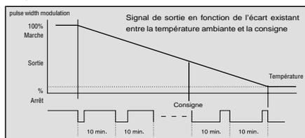
La somme des temps d'impulsion et de pause reste constante; elle est de 10 minutes. En sortant de la zone proportionnelle, la sortie est activée en permanence ou désactivée en permanence. Le thermostat cherche à maintenir la température ambiante constante et, de ce fait, envoie des impulsions même quand la température est atteinte.
