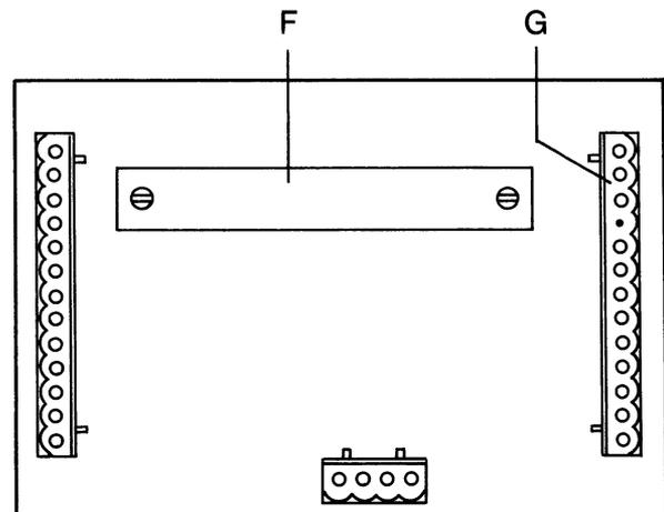
Bei Inbetriebnahme des WG 100/200 ohne Regelgerät ist die Brückensteckplatine (F) auf die Buchsenleiste (G) zu rasten. Der Funktionsschalter muß in diesem Fall in Stellung >
