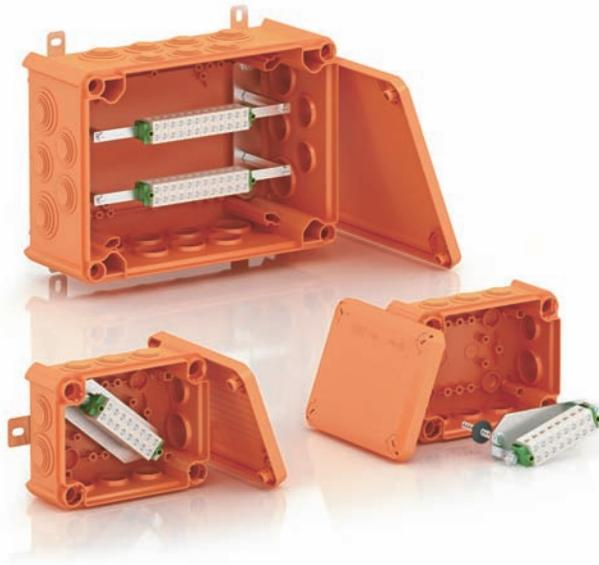
Halogenfreier Kabelabzweigkasten mit weichen Einsteckdichtungen, inklusive Anschlusseinheit aus hochtemperaturbeständiger Spezialkeramik und gekennzeichnete Schutzleiterklemme für Innen- und Außenbefestigung. Lieferung mit 2 Brandschutzschraubankern MMS 6x50 zur dübellosen Befestigung. Hohe Schutzart IP65, Schlagfestigkeitsklasse T100ED... IK08; T350ED... IK06.
