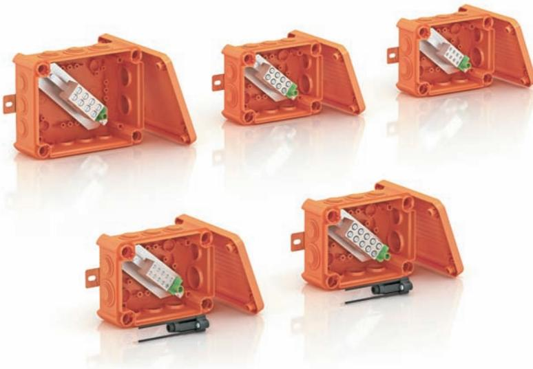
Halogenfreier Kabelabzweigkasten mit weichen Einsteckdichtungen, inklusive komplett montierter Anschlusseinheit aus hochtemperaturbeständiger Spezialkeramik, gekennzeichnete Schutzleiterklemme und Außenbefestigung. Lieferung mit 2 Brandschutzschraubankern MMS 6x50 zur dübellosen Befestigung an den Außenlaschen. Hohe Schutzart IP65, Schlagfestigkeitsklasse T100ED... IK08; T160ED... IK05.
