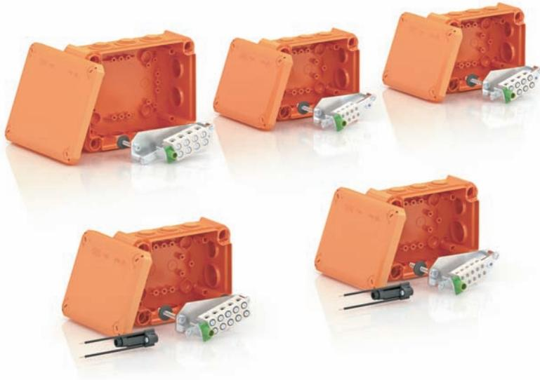
Halogenfreier Kabelabzweigkasten mit weichen Einsteckdichtungen, inklusive vormontierter Anschlusseinheit aus hochtemperaturbeständiger Spezialkeramik und gekennzeichnete Schutzleiterklemme. Lieferung mit 2 Brandschutzschraubankern MMS 6x50 zur dübellosen Befestigung durch den Kastenboden. Hohe Schutzart IP65, Schlagfestigkeitsklasse T100ED... IK08; T160ED... IK05.
