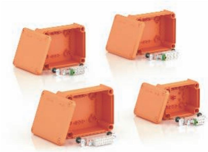
Halogenfreier Kabelabzweigkasten in geschlossener Ausführung, inklusive vormontierter Anschlusseinheit aus hochtemperaturbeständiger Spezialkeramik und gekennzeichnete Schutzleiterklemme. Lieferung mit 2 Brandschutzschraubankern MMS 6x50 zur dübellosen Befestigung durch den Kastenboden. Hohe Schutzart IP65, Schlagfestigkeitsklasse T100ED... IK08; T160ED... IK05. Frei wählbare Positionierung der Kabelausgänge mit V-TEC-Verschraubungen in den Seitenwänden.
