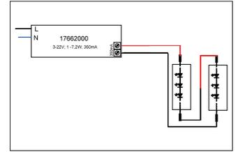
LED-Konverter 350 mA, schaltbar Dieser Konverter ist durch Sicherungseinrichtungen gegen Überspannung und Kurzschluss sowie thermische und elektrische Überlastung geschützt. Die Eingangs- und die Ausgangsklemme ist für Leitungen mit einem Querschnitt von bis zu 1,5 mm<sup>2</sup> geeignet. Material: Kunststoff, Schutzart: nach DIN EN 60529: IP20, Schutzklasse: (EN 61140) II, Spannung: 230V AC 50Hz, Leistung: 7.2W, Dimmbar: Nein, Art der Dimmung: schaltbar .
