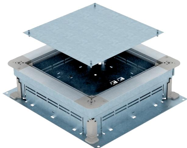
Unterflur Zug- und Abzweigdose für estrichüberdeckte Unterflur-Installationskanäle mit Seitenwänden aus Stahlblech. Zur Montage von Einbaueinheiten in Montagegedeckel (separat zu bestellen). Lässt sich stufenlos auf Estrichhöhe nivellieren (Schnellnivellierung möglich) und der Estrich kann bündig an die Estrichabzugskante angearbeitet werden. Mit schalltechnischer Entkopplungsmöglichkeit nach Estrichverlegung und mit Systemzubehör auch für Schwerlastanwendung verwendbar.
