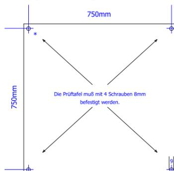
Vorhandene Bohrungen in der Prüftafel-Rückwand
