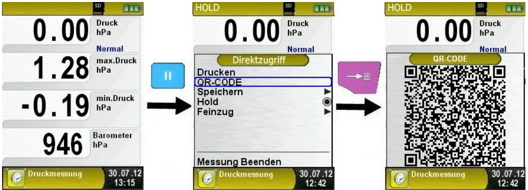
Bild 9: QR-Code Generierung, Bsp.: Druckmessung
