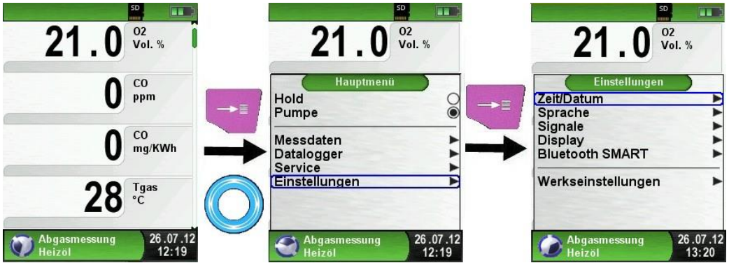
Bild 11: Konfigurationsmenü „Einstellungen“ im Hauptmenü, Bsp.: Abgasmessung
