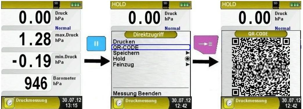
Bild 9: QR-Code Generierung, Bsp.: Druckmessung
