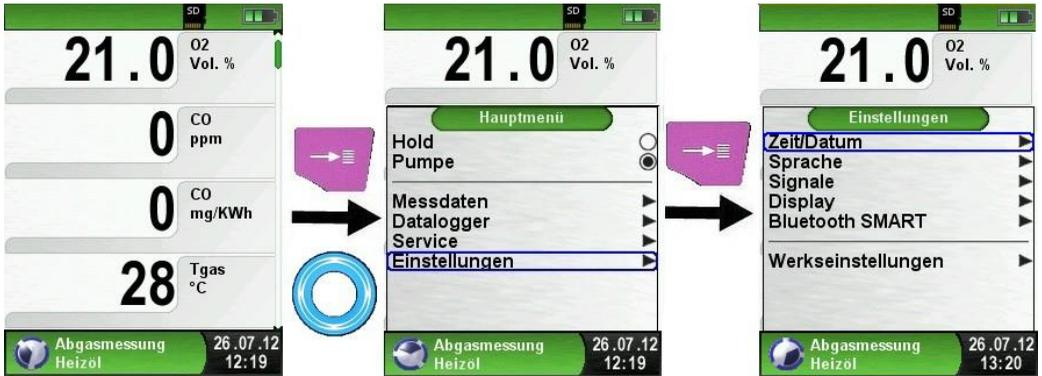
Bild 11: Konfigurationsmenü „Einstellungen“ im Hauptmenü, Bsp.: Abgasmessung
