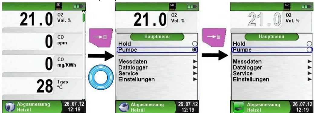
Bei ausgeschalteter Gaspumpe wird in der Statuszeile das Pumpensymbol durch das zugehörige Programmsymbol ersetzt. Die Gasmesswerte werden nun in grauer Farbe dargestellt. Dabei ist nicht auszuschließen, dass entsprechende Gasmesswerte sich ändern können, z. B. der O<sub>2</sub>-Wert aufgrund von „Sauerstoffmangel“ in den geräteinternen Gaswegen. Wird die Gaspumpe für längere Zeit ausgeschaltet, so sollte vor einer neuen Messung eine neue Frischluftkalibrierung durchgeführt werden.
