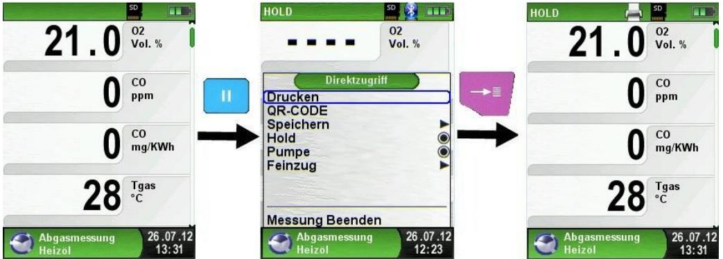
Bild 7: Direktzugriffsmenü, Bsp.: Abgasmessung
