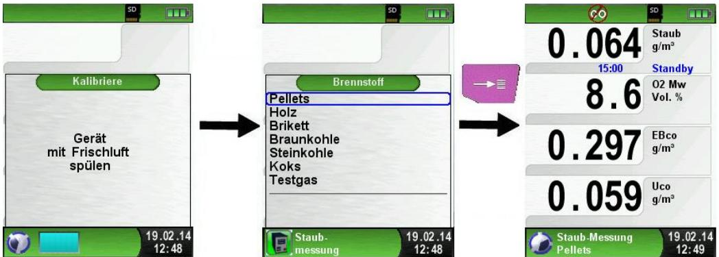
Nun müssen die Parameter am Staubmessgerät gewählt werden. Sobald das Staubmessgerät bereit ist, wird dies auch im MULTILYZER® STE dargestellt. Jetzt kann die Messung entweder am Staubmessgerät oder am MULTILYZER® STE gestartet werden.
