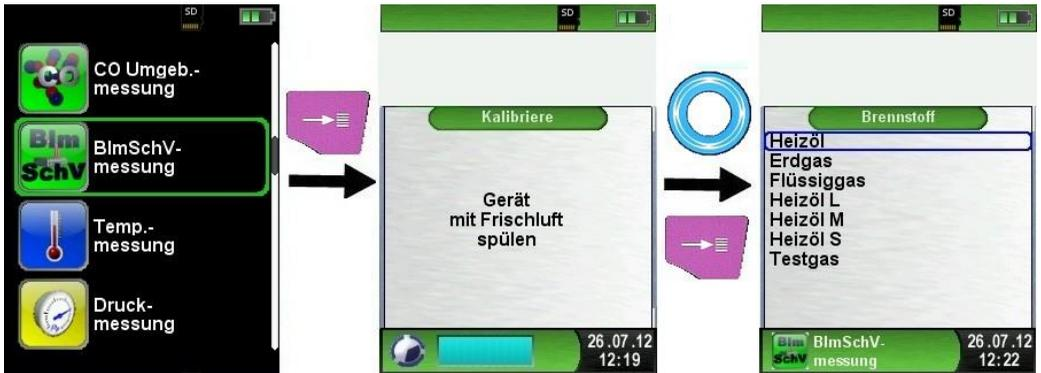
Danach kann man die Abgassonde ins Kamin- bzw. Abgasrohr einführen. Wenn der O<sub>2</sub>-Wert unter 20% sinkt und beide Temperaturfühler angeschlossen sind, dann wird die 30 Sek. Mittelwertmessung gestartet. Nach den 30 Sekunden wird der berechnete q<sub>A</sub>-Wert angezeigt. Die q<sub>A</sub>-Mittelwertmessung läuft dann kontinuierlich weiter.
