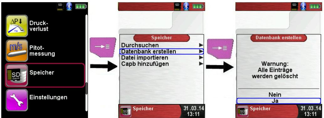
Bei der Prozedur wird auf der MicroSD-Karte eine DATABASE.CSV Datei erstellt, dies stellt die Speicherstruktur des Abgasmessgerätes MULTILYZER® STe dar. Die Prozedur dauert wenige Sekunden.
