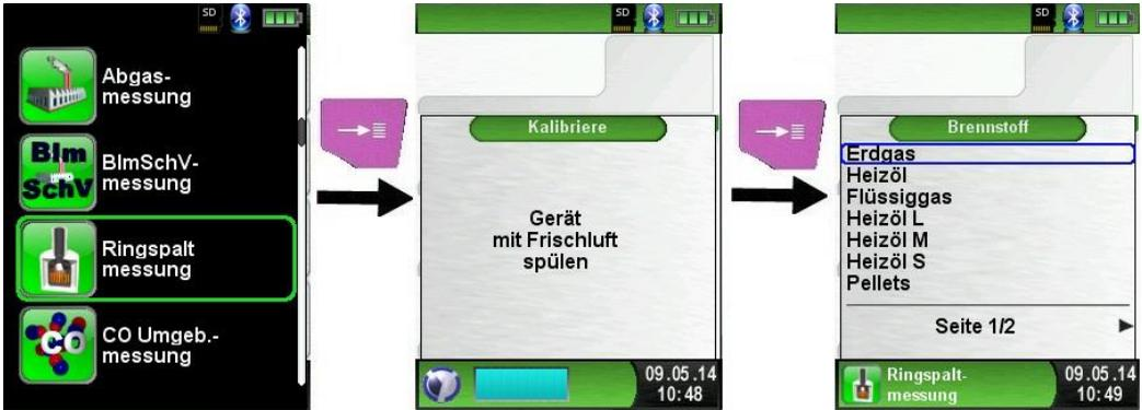
Es kann sowohl eine CO-Messung nach KÜO (Kehr- und Überwachungsordnungen der Bundesländer) als auch eine Ringspaltmessung (O<sub>2</sub>-Differenz im Ringspalt) durchgeführt werden. Somit wird ermittelt, ob Abgase in die Verbrennungsluft gelangen. Dazu gibt es als Zubehörartikel die Ringspaltsonde.
