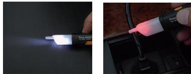
Der **HT20S** ist ein praktischer berührungsloser Spannungsprüfer in Stiftform, der eine vorhandene Wechselspannung durch einen akustischen Summton und eine rot aufleuchtende LED in der Prüfspitze anzeigt.
