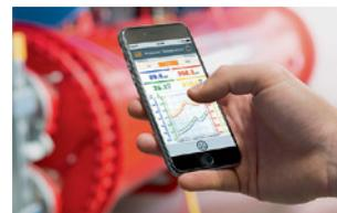
Connexion à l'App via Bluetooth pour l'affichage des données de mesure sur les appareils mobiles et la finalisation des protocoles de mesure sur site.
