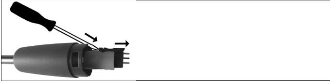
2. Steckkopf des Thermoelements mit Hilfe eines Schraubendrehers aus der Fassung lösen und Thermoelement aus dem Sondenrohr ziehen.
