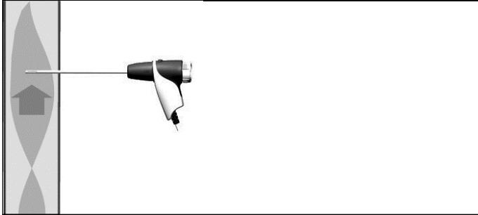
Die Sondenspitze muss sich im Kernstrom des Abgases befinden.
