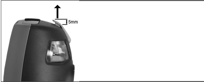
1. Kondensatbehälter entriegeln und waagrecht von der Analysebox abziehen.
