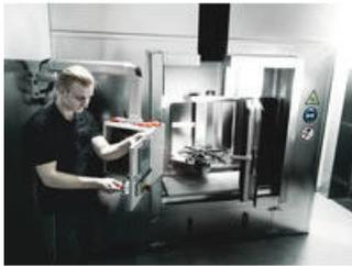
Die Stückprüfung bei 10.000 Volt gemäß IEC 60900 garantiert sicheres Arbeiten unter Spannung bis 1.000 Volt.
