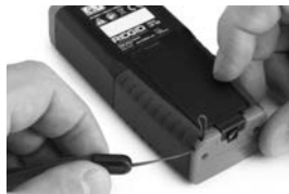
Figura 4 – Instalación del cordón
