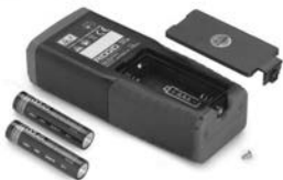
Figur 5 – Udskiftning af batterier
