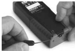
Рис. 4 – Установка ремешка для крепления прибора на запястье
