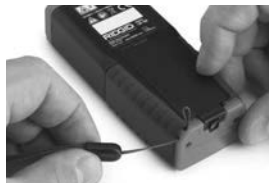
Figura 4 – Instalação da Correia
