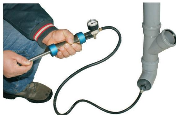
*Kit per il collaudo impianti di scarico fino a Ø 300. Con pompa completa di tubo e manometro, rubinetto scarico e mantenimento. Di serie 3 palloncini sonda Ø 40/60- 60/80- 90/110*
