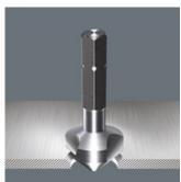
3-nutiger Kegelsenker-Bit, 90° • Einsatz: Zum Entgraten, Fasen, Senken • 1/4"-Antrieb passend für Halter nach DIN 3126-D 6,3 (ISO 1173) • Sehr gute Kraftübertragung durch Sechskant-Schaft HSS Hochleistungsschnell-Stahl • Fein abgestimmte Material- Elastizität für hohe Standzeiten • 3 Schneiden • Sehr Zentriereigenschaften Problemloses Schneiden Einwandfreie Spanabfuhr Geringe Verkantungsgefahr Präzise Rücklaufführung • Hoher Korrosionsschutz
