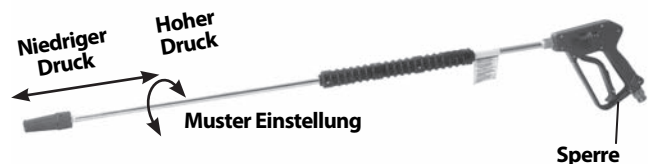
Abbildung 17 – Einstellungen der Waschlanze-Düse
