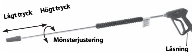
Figur 17 – Justering av tvättverktygets munstycke
