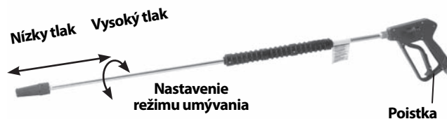
Obrázok č. 17 – Nastavenia hubice umývacej pištole
