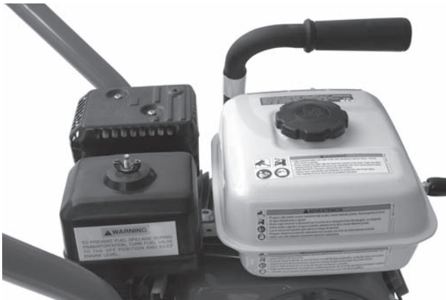
Slika 6B – KJ-2200 upozoravajuće naljepnice
