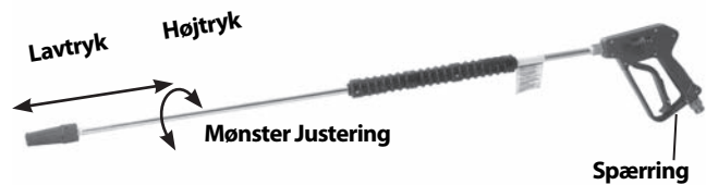
Figur 17 – Justering af rensstangens dyse
