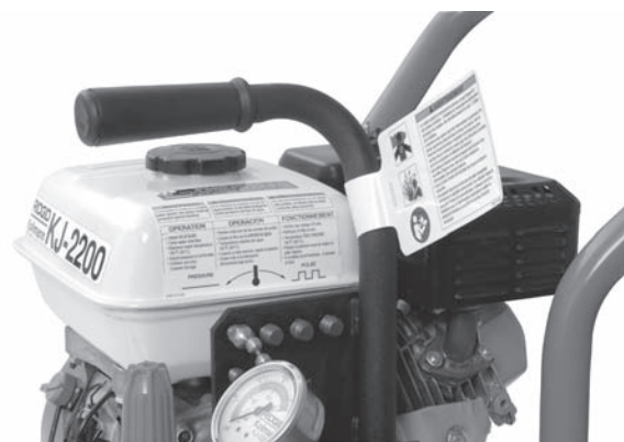
Obrázok č. 6A – Výstražné štítky KJ-2200
