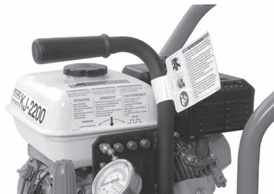
6A ábra – A KJ-2200 figyelmeztető címkéi
