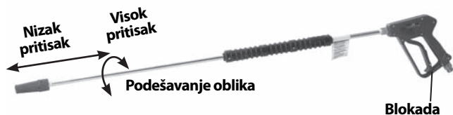
Slika 17 – Podešavanje brizgaljke na štapu za pranje
