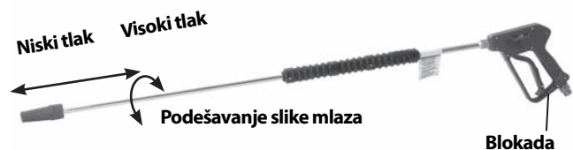
Slika 17 – Postavke mlaznice pištolja
