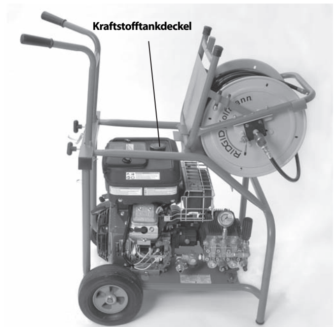
Abbildung 8 – KJ-3100 Zugang zum Kraftstofftank
