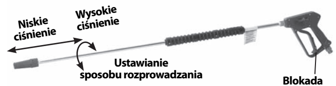
Rysunek 17 – Regulacja dyszy lancy myjki
