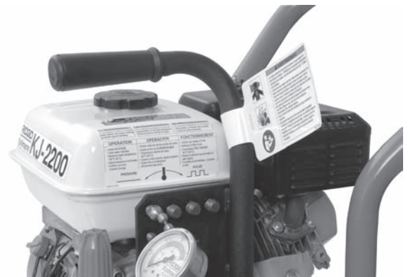
Figuur 6A – KJ-2200-waarschuwingslabels
