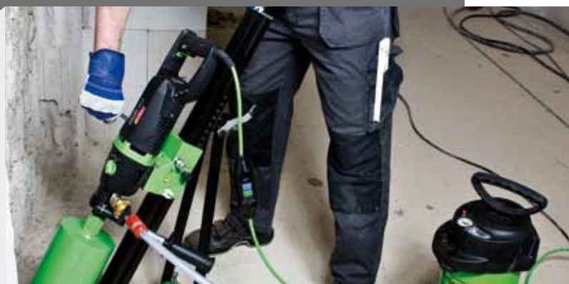
BST 182 V/S: auf vier Spezialkugeln gelagerter Schlitten
