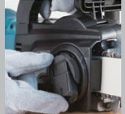
Verbesserte Ölpumpe sorgt für gleichmäßige Ölversorgung unabhängig von Temperatur und Viskosität
