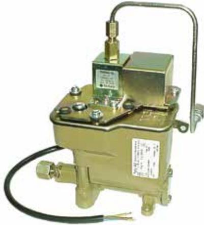
steuert die zufließende Ölmenge zum Brennertopf. Durch ruckartiges Herausziehen des Einschubbrenners IHS-W 2000 kann der Sicherheitsschwimmer auslösen. Deshalb sollte nach jedem Einschieben des Brenners der Sicherheitshebel nach oben gedrückt werden, um unnötigen Störungen vorzubeugen. Bei der jährlichen Wartung ist der Ölfilter zu überprüfen und gegebenenfalls zu reinigen. Ist der Ölregler schräg eingebaut, so kann der Sicherheitsschwimmer ebenfalls auslösen.
